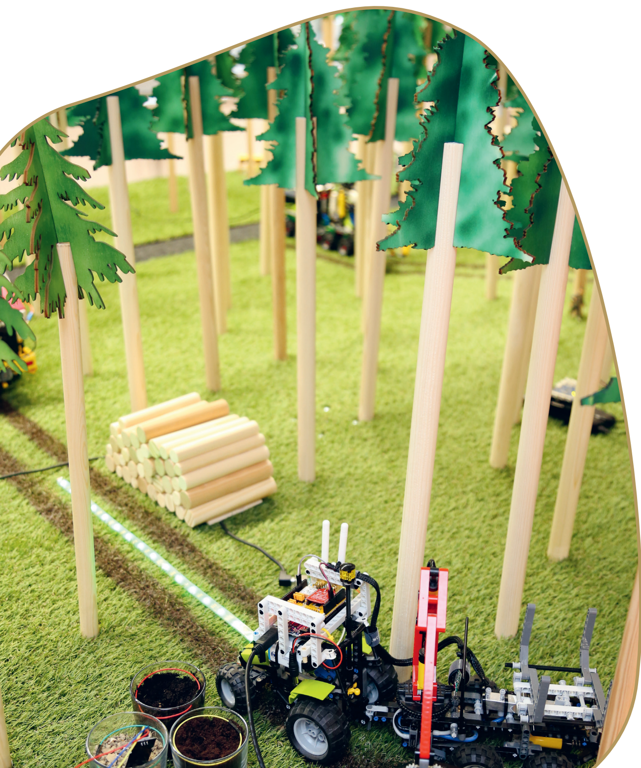
Szenario zur Bodenbefahrbarkeit mit Bodenfeuchte-Sensoren und Kranwaage.
