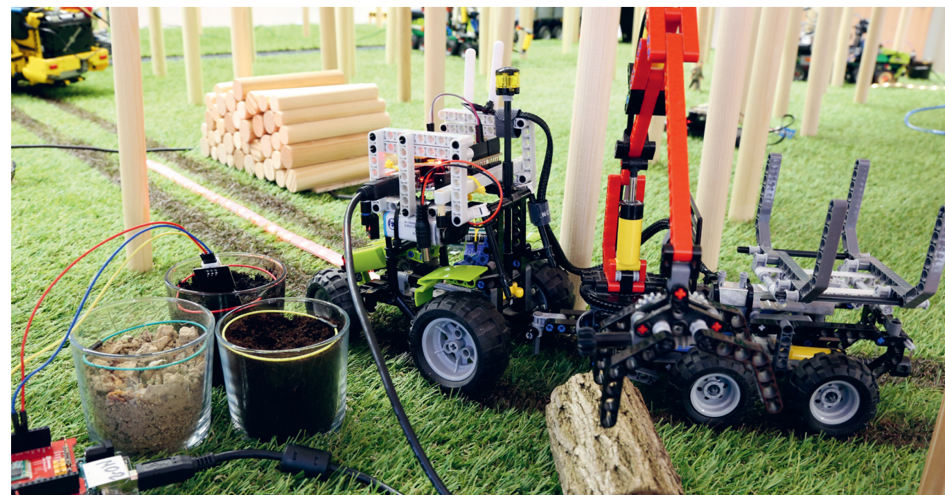
Im gamifizierten Smart Forest Lab sind der reale Waldbestand, die Maschinen sowie die Rückegassen nachgebaut und mit Sensoren versehen. Es kommt die gleiche Software wie im realen Wald zum Einsatz.
